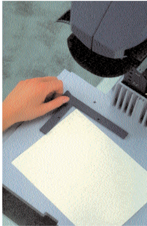
Legen Sie das Papier auf das Grundbrett und drehen Sie das Rotfilter ein.
