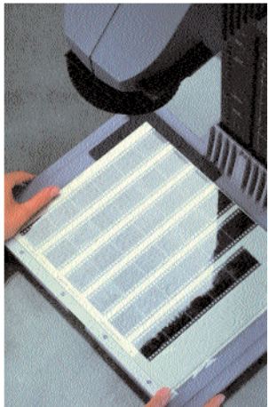
Eine Glasplatte hält alles plan. Belichtet wird mit weicher Gradation.
