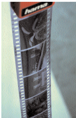
Hängen Sie den Film an einen staubfreien Ort. Nach etwa 60 Minuten ist er vollständig trocken.
