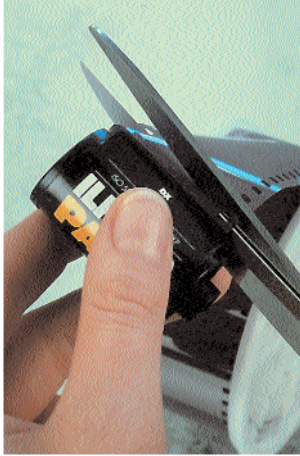
Ist der Film komplett eingespult, wird er am Patronenmaul abgeschnitten.
