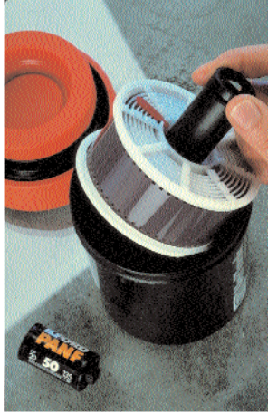
Dann verschwinden Film und Spirale in der Entwicklerdose, Deckel schließen.
