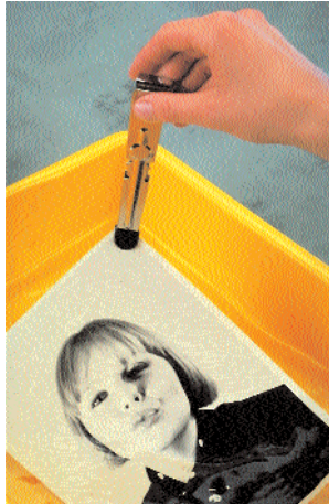
Etwa 15 Sekunden ins Stoppbad, dann eine Minute in den Fixierer.
