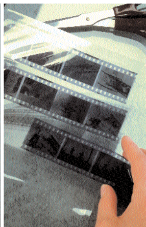
Der trockene Film wird in Sechserstreifen geschnitten und sicher in einer Archivhülle verstaut.
