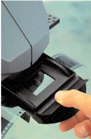
Achten Sie auf Fussel auf dem Negativ, dann löschen Sie das Raumlicht.
