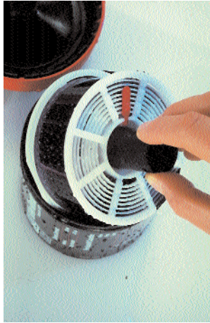
Nach fünf Minuten öffnen Sie die Dose und entnehmen die Spirale.
