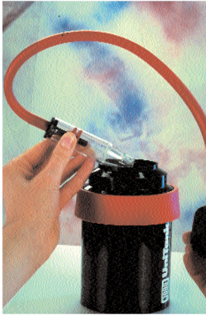
Zum Wässern sollten Sie am besten eine Schnellwaschhilfe verwenden.
